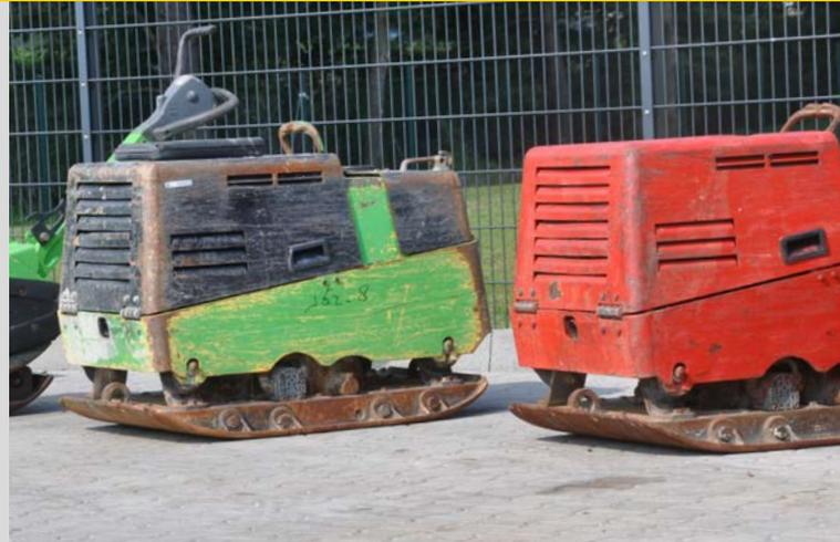
Die Bomag Rüttelplatte BPH 80/65 S ist durch Ihren hydraulischen Antrieb & der Abschaltautomatik bei Ölmangel Leistungsstark und Wartungsarm. Mit dem Kraftvollen Hatz Dieselmotor kann diese kompakte Rüttelplatte eine Fläche von bis zu 130 m<sup>3</sup> auf Kies oder Sand pro Stunde bearbeiten. Ausgestattet mit einer Hochverschleißfesten Grundplatte in 3 Verschiedenen Größen von 650 - 950 mm mit verstärkten Aussenkanten.
