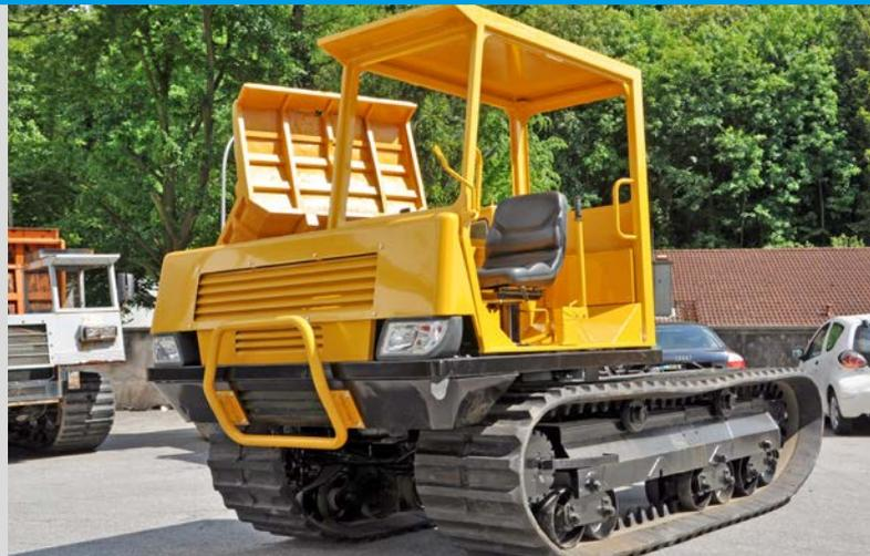
Der Hanix RT1000 hat ein Eigengewicht von 10,2 Tonnen das durch die 600 mm Gummiketten Laufwerke auf nur 0,15 kg/cm<sup>3</sup> verteilt wird.
