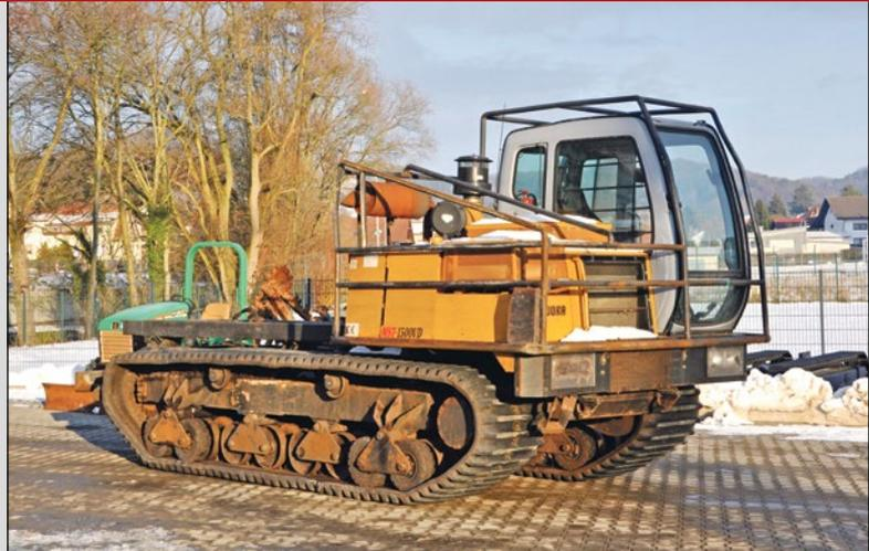
Einfache Bedienung durch das HST-System bei dem es keine Pedale oder Bedienhebel zum Verstellen der Geschwindigkeit gibt. Die Bedienung erfolgt einfach über einen einzigen Bedienungshebel.
