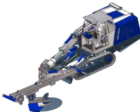
Waagrechtes Schneiden auf der Sohle
