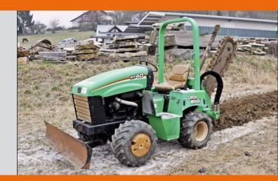
Dieser Traktor mit 40 PS (29,8 kW) starkem Deutz Motor ist Mitglied der RT Traktor-Linie und bietet die gleiche robuste Zuverlässigkeit des RT55 in einem kleineren, flexibleren Paket. Der RT40 ist mit einer Verbundstoff Motorhaube. einer leicht zu lesenden Instrumententafel und zweirädrige Servolenkung ausgestattet. Zudem wurde der Traktor mit dem Ziel entwickelt multiple Anbaugeräte wie Fräsen, Vibrationspflüge, Baggeranbauten und weitere Ditch Witch Anbaugeräte zu Unterstützen.
