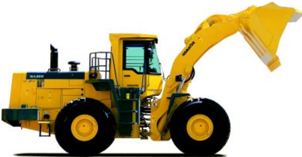
Leistungsstarker und sparsamer *Komatsu Niederemissionsmotor* mit kennfeldgesteuerter Common-Rail Einspritzanlage. Erfüllt die europäischen Abgasrichtlinien gemäß TIER II. (Seite 4)
