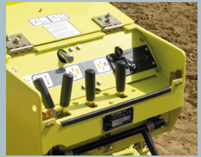
Modernes, übersichtliches Cockpit mit Funktionsüberwachung und Fehlerdiagnosesystem
