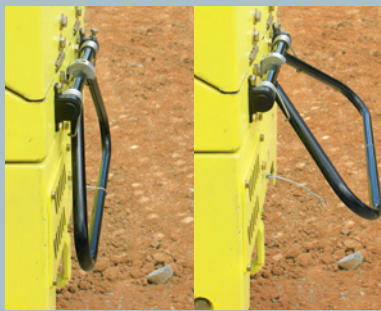
Arretierbarer Sicherheitsbügel zur Sicherheit des Bedieners
