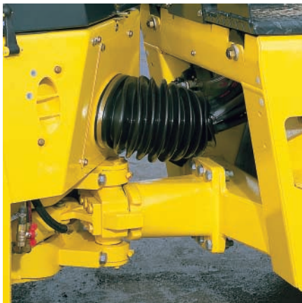
Pendelknickgelenk: solide und wartungsfreundlich
