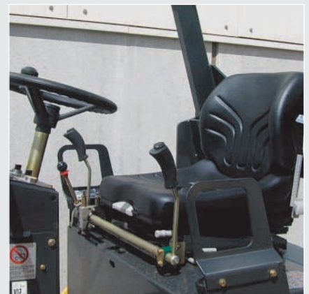
Doppelfahrhebel: Für komfortable Bedienung.
