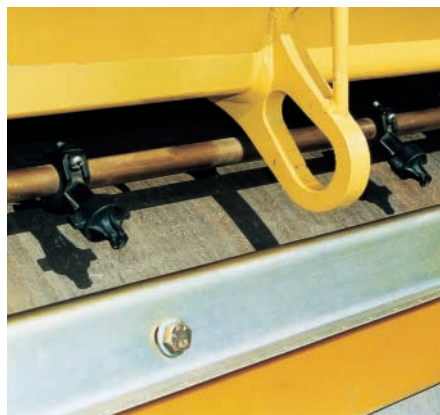
Düsen mit Bajonettverschluß: direkt zugänglich und schnell zu reinigen
