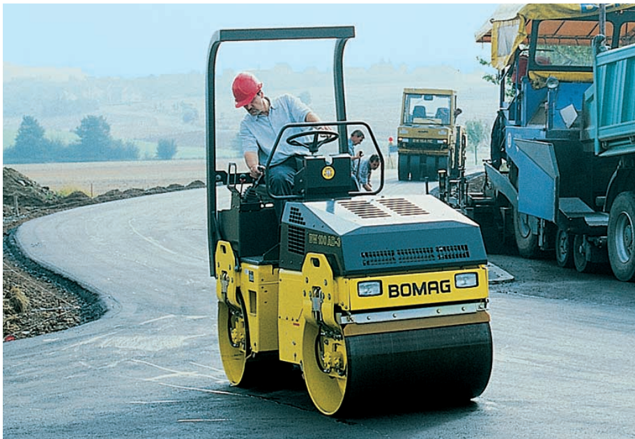
BW 100 AD-3: Schwingungsisolierter Fahrerstand; gute Sicht durch abgeschrägte Motorhaube
