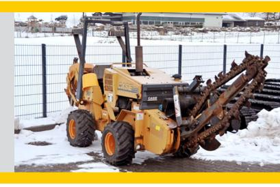
Die Grabenfräse vom Typ 360 der Firma CASE ist mit einem Deutz Dieselmotor mit 32 PS ausgestattet. Egal ob Sie eine neue Bahn der Datenautobahn oder eine Andere Form von unterirdischen Versorgungsleitungen legen, diese Traktoren sind Top-Performer in ihrer Klasse. Sie erfüllen Ihre Aufgabe auch in den härtesten unterirdischen Umgebungen. Der CASE 360 kann zusätzlich zur Grabenfräse auch noch mit einem Anbaupflug, Hydra-Borer System, Felsensäge und Bagger-Anbau ausgerüstet werden.
