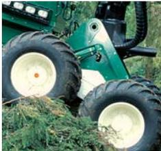
Die niedrige Kranbefestigung verleiht der Maschine einen extrem niedrigen Schwerpunkt. Alle Boggies sind verschießbar, wodurch die Seitenstabilität hervorragend ist, und der Kran lässt sich auch mit voller Präzision auf schwierigem Gelände fahren.
