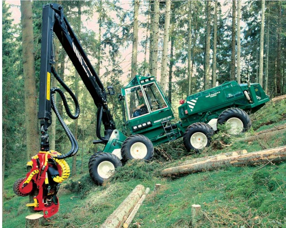
Die einmalige Längs-stabilität ermöglicht das Arbeiten im abschüssigen Gelände mit voller Kapazität.
