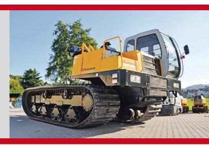
Einfache Bedienung durch das HST-System bei dem es keine Pedale oder Bedienhebel zum Verstellen der Geschwindigkeit gibt. Die Bedienung erfolgt einfach über einen einzigen Bedienungshebel. Die einzigartigen, mittig aufgezogenen Spurrollen sichern den Dumper vor dem Abstürzen. Die schrägen Laufrollen bewähren sich ebenfalls hervorragend auf unebenem weichen und steilen Untergrund.
