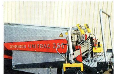
Dank der abnehmbaren Steuereinheit besteht die Möglichkeit, die Maschine mitgängergeführt zu bedienen und dadurch mit dem Fertiger exakt und problemlos zu arbeiten.
