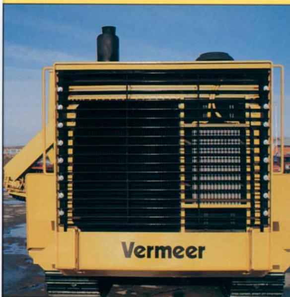
Durch die spezielle Konstruktion liegen Kühler / Ölkühler nebeneinander. Diese Anordnung erhöht nochmals die Effektivität.
